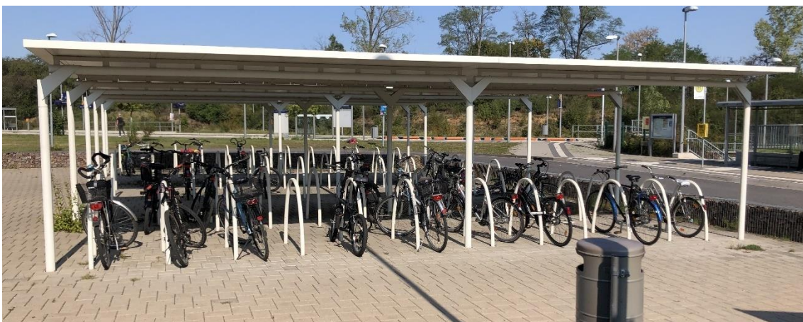
Abbildung 38: Beispiel überdachte Fahrradabstellanlage mit Radanlehnbügel
